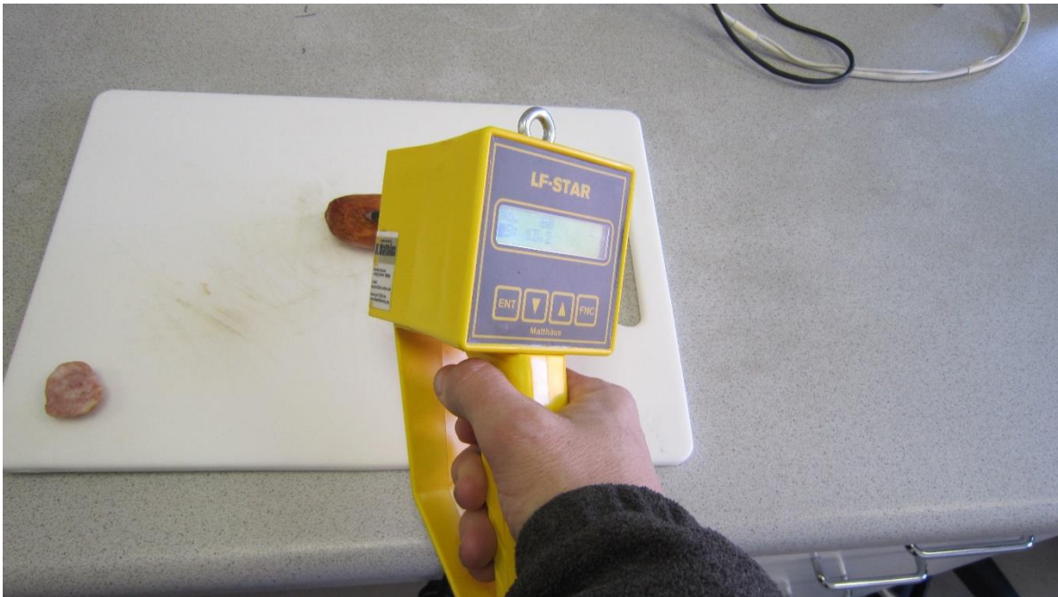
Joonis 9. Lihase elektrijuhtivuse määramine seadmega LF-Star CPU (S. Sild)
