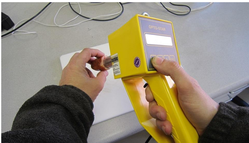
Joonis 7. Lihase pinna värvuse määramine seadmega Opto-Star (S. Sild)
