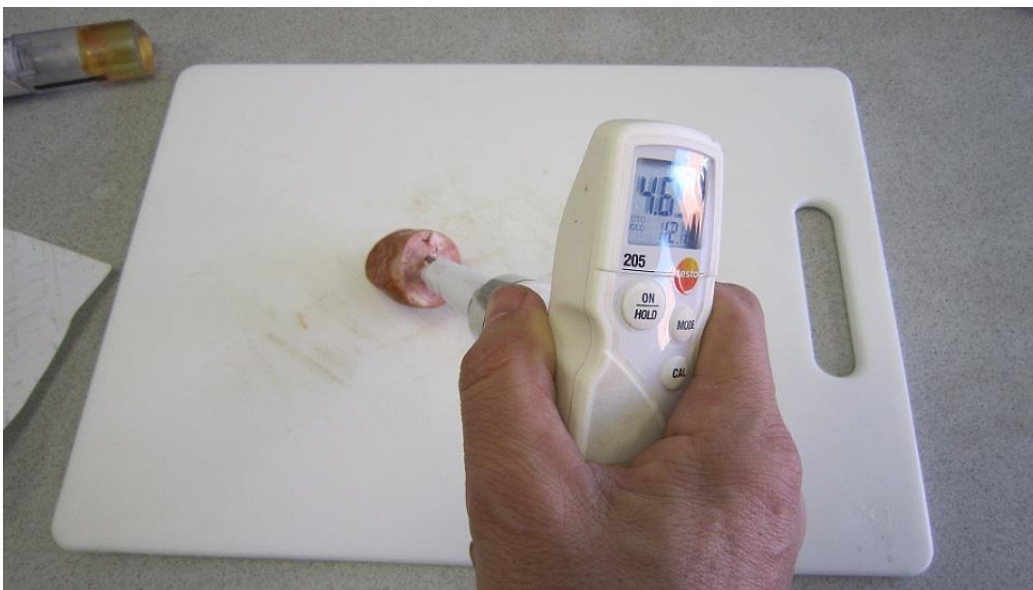
Joonis 8. Lihase pH-väärtuse määramine seadmega Testo 205 (S. Sild)
