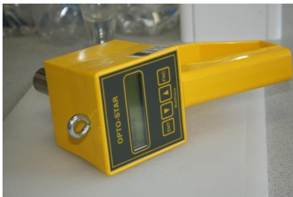
Joonis 15. Liha värvuse määraja Opto Star (Tänavots, A)
