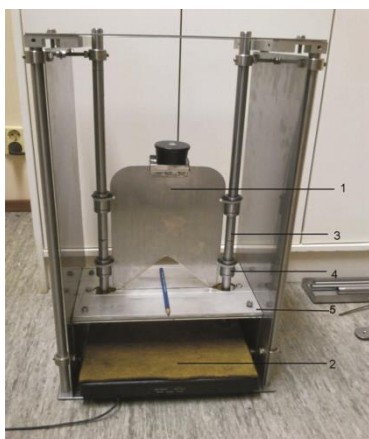
Joonis 18. Katseseade liha lõikeenergia määramiseks gravitatsioonilise impulssmeetodiga (Lepasalu, L) (1 – lõiketera, 2 – jõuanduri platvorm, 3 – juhtvardad, 4 – liuglaager, 5 – lõikelaud)
