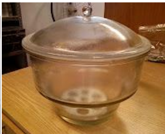
Joonis 12. Eksikaator (Pöldvere, A)
