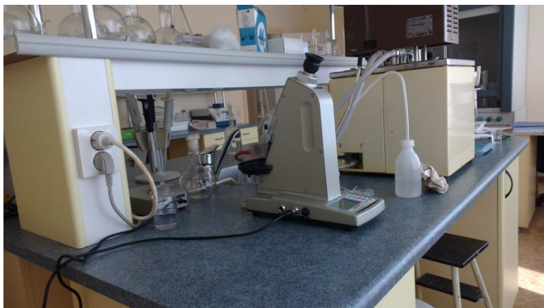
Joonis 19. Refraktomeeter (Torga, T)
