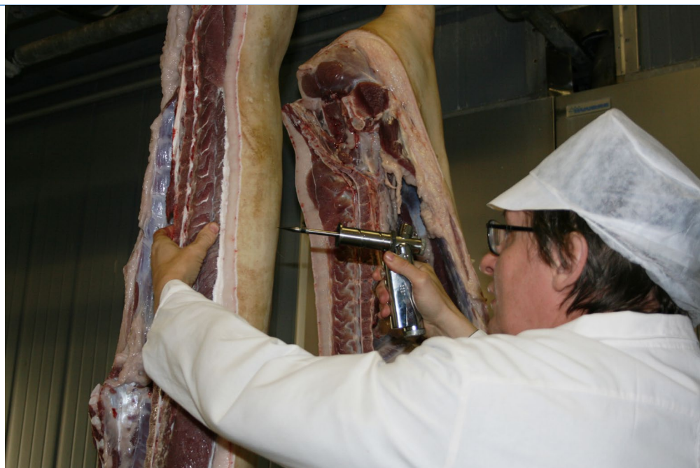
Eesti Tõusigade Aretusühistu aretusspetsialist-lihatehnoloog Aarne Põldvere määrab lihatööstuses searümpade tailhisasisaldust mehaanilise taimõoturi ehk intraskoobiga. Foto: Alo Tänavots
